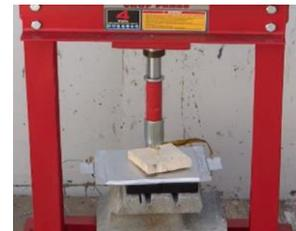
写真:LTO/25Ahセルの釘刺し試験
