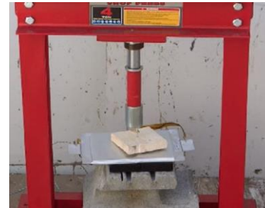
写真:LTO/25Ahセルの釘刺し試験 発煙・発火無し
